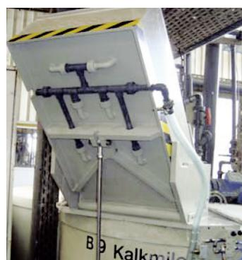
die das staubende Ausleeren des Calciumoxids per Hand vermeidet. Dazu wird der Sack Calciumoxid in eine Vorkammer mit spitzen Sprühdüsen gegeben und T-förmig aufgeschnitten. Die Vorkammer wird spritzwasserdicht verschlossen und hydraulisch angehoben. Mittels der in den Sack eingestochenen Wasserdüsen wird der Sack komplett ausgespritzt und in den Ansatzbehälter entleert. Der leere Sack verbleibt in der Vorkammer und kann nach dem Absenken der Kammer entnommen werden.
