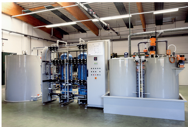
Komplettanlage zur Entfernung von Nickel aus dem Spülwasser für das Anodisieren von Aluminium
